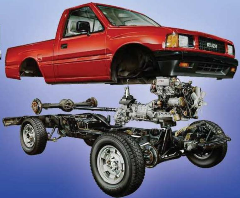
မော်တော်ယာဉ်တစ်စီးတွင် Engine parts , Drive Transmission & Steering , Suspension & Brake Parts , Electrical Parts , Cab Body & Chassis စသည် အမိကကျေသာ အပိုင်းကြီး (၅) ပိုင်း ပါဝင်ပါသည်။ ထိုအပြင် အစိတ်အပိုင်းပေါင်း (၃၀၀၀၀) ခန့်ဖြင့် ဖွဲ့စည်းတည်ဆောက်ထားပါသည်။
