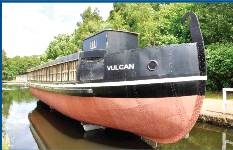
Rivet Type ဖြင့် တည်ဆောက်ထားသော ရေယာဉ်တစ်စင်း
